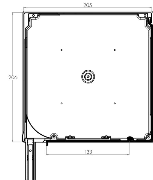
MAXIMUM ROLLER SHUTTER HEIGHT (WINDOW HEIGHT + BOX HEIGHT) IN MM
